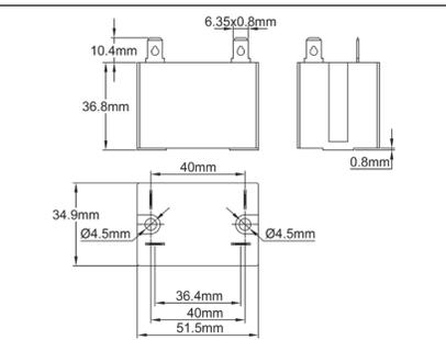
1 × 30A 250V résistif (AC1) (CE et UL) contact NO, Boitier étanche, languettes 6.35 × 0.8. Ce contacteur peut se monter directement sans platine de montage sur toutes les faces avant plastique décalées prévues pour les thermostats à bulbe et capillaire et régulateurs électroniques, ainsi que sur les face avant plates des coffrets de distribution de ce catalogue. Bobine 200-240V alternatif
