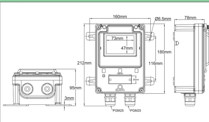
Permet le montage d'un disjoncteur type Merlin Gerin Multi9 (UL, CSA, CEI) ou des gammes européennes équivalentes C60 ou Vigi C60 (largeur maximale 72mm= 4 modules de 18mm).
