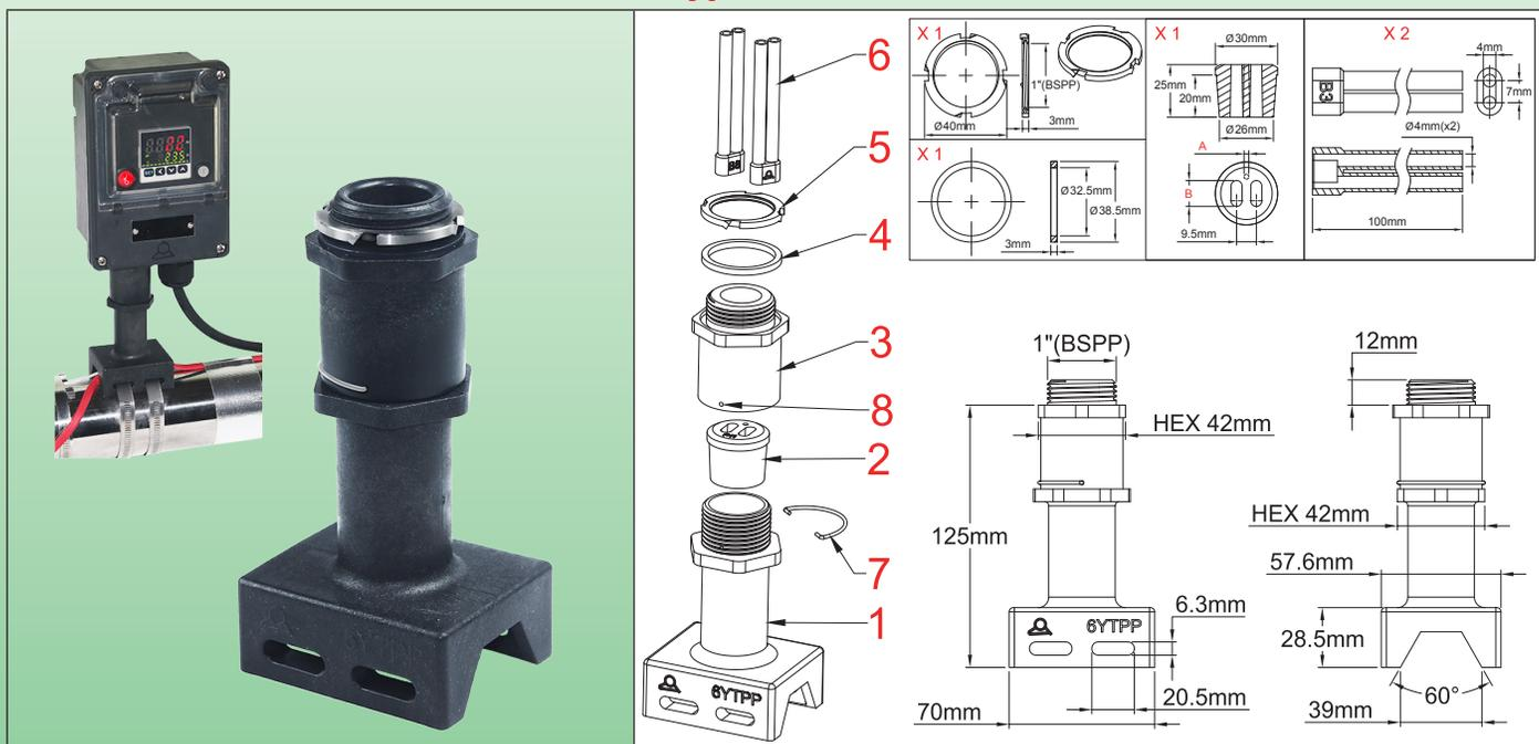
1: Partie inférieure du pied; 2: Joint de passage des câbles chauffants et du câble de capteur de température éventuel; 3: Partie supérieure du pied; 4: Joint de boîtier; 5: Ecrou de boîtier; 6: Capuchon isolateur des conducteurs; 7: Ressort de verrouillage; 8: Passage de la tige du ressort de verrouillage; 9: Trou borgne de verrouillage.
