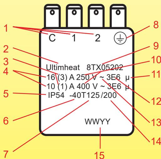
1 : Identification de bornes qui sont appropriée pour le raccordement des conducteurs externes, et si elles sont appropriées pour la phase ou le conducteur de neutres, ou les deux.
