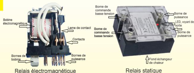
**Le relais ou contacteur électromécanique :** La bobine est constituée d'un très grand nombre de spires d'un fil de cuivre très fin. Quand cette bobine est parcourue par un courant suffisant, elle produit un champ magnétique qui attire la partie mobile et déplace les lames souples munies de contacts électriques. Quand plus aucun courant ne circule dans la bobine, les contacts reprennent leur position de repos grâce à un ressort de rappel.
