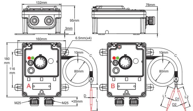
**A:** Modèles à un bulbe, uniquement régulation de température
