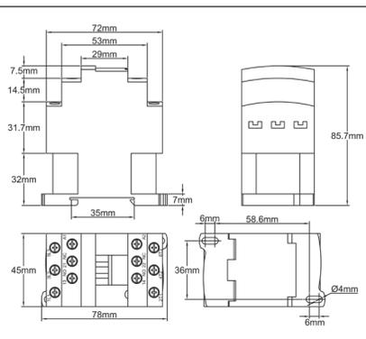
3 × 25A ou 3 × 32A 250/400V résistif (AC1), bornes à vis, bobine 240V ou 400V alternatif. Contacteur normalisé selon IEC947-1 (EN60947-1), son encombrement important limite cependant son application dans les coffrets. Il est incompatible avec la série Y8, mais peut se monter dans les séries Y6 et Y7 comportant un thermostat unipolaire .
